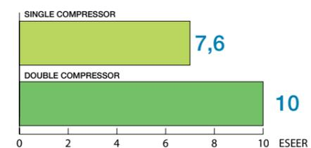
В агрегат **CENTRITEK** минимальная производительность 10% от максимальной для однокомпрессорных моделей и 5% для двухкомпрессорных установок. Это позволяет значительно экономить энергию и увеличивать срок службы компрессора, уменьшаются чрезмерные нагрузки с помощью его устойчивостью предельным вибрациям.
